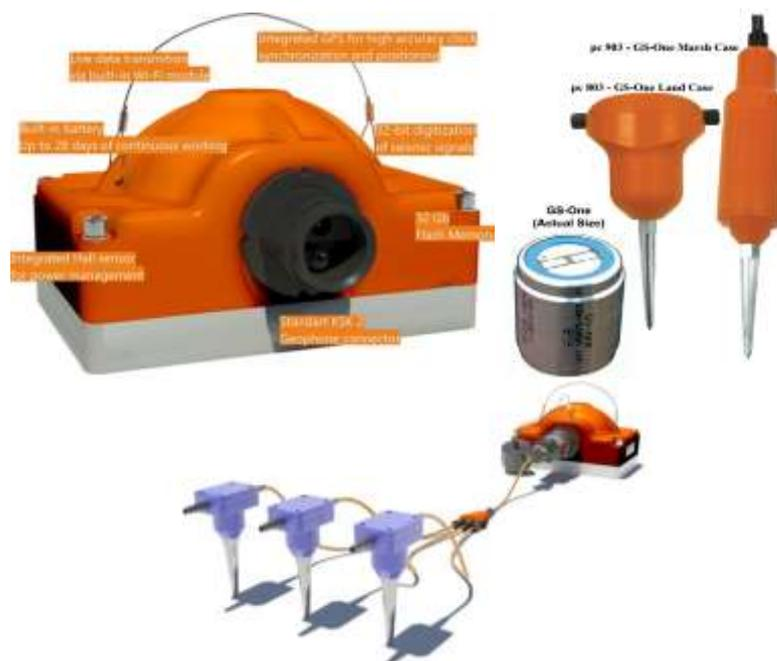
Рисунок 1 – Трехканальная цифровая сейсмическая станция Scout, снаряженная сейсмическими датчиками GS-One.
